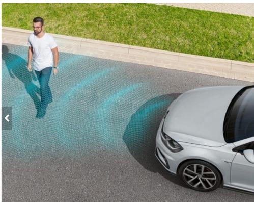
**'Front Assist'** En cas de situation non anticipée, un freinage d'urgence peut être nécessaire. Et la technologie 'Front Assist' peut devenir un allier de poids. Vous serez averti par une alarme si une situation dangereuse est détectée. En cas de menace grave, le système aide au freinage et peut même déclencher un freinage automatique pour réduire la vitesse de collision, ou même l'éviter.
