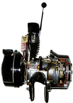
Le **bloc-moteur** est situé au dessus de la roue avant du Solex.
